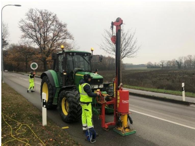
Figure 11 : Chute de poids Vector PowerDrive 1+
