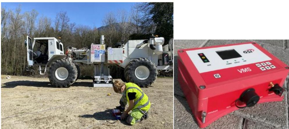
Figure 48 : mesures de vibrations au moyen de l'appareil GSI VMS
