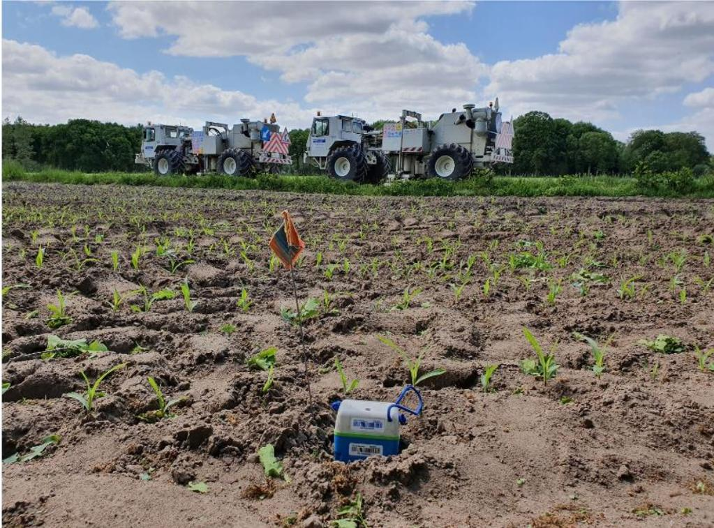
**Figure 15 : boitier DTCC SmartSolo et vibrateurs Ivi Mark4 en acquisition**
